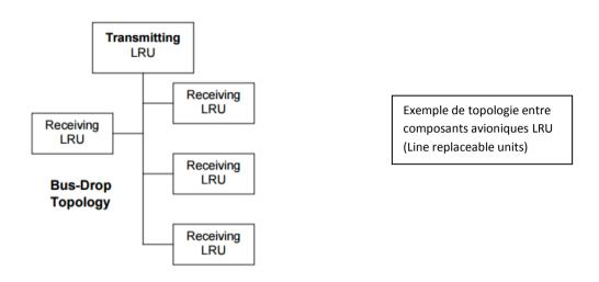
Physiquement les signaux électriques sont transmis à travers des paires torsadées 78  $\Omega$ , chaque paire pouvant connecter un transmetteur à 20 récepteurs maximum.
