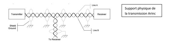
La norme Arinc définit : les niveaux électriques, la vitesse et le protocole de transmission des données.
