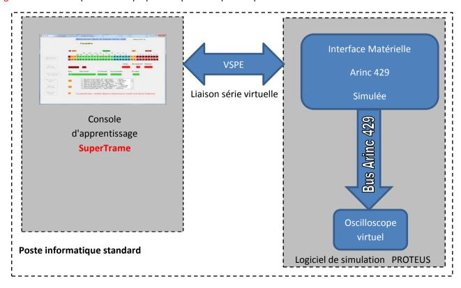
L'utilisateur choisit une trame sur sa console d'apprentissage (SuperTrame). L'information est transférée via la liaison série virtuelle. Le système simulé transmet la trame au standard ARINC de manière périodique. L'utilisateur peut câbler un oscilloscope virtuel et ainsi visualiser les signaux afin de les caractériser.
