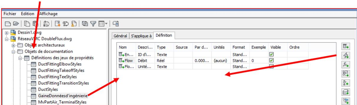
Dans « GainsDonnéesd'ingénierie », rajouter « Diamètre de connexion » en cliquant sur l'éclair à droite de la fenêtre puis OK et de même pour « Longueur » .
