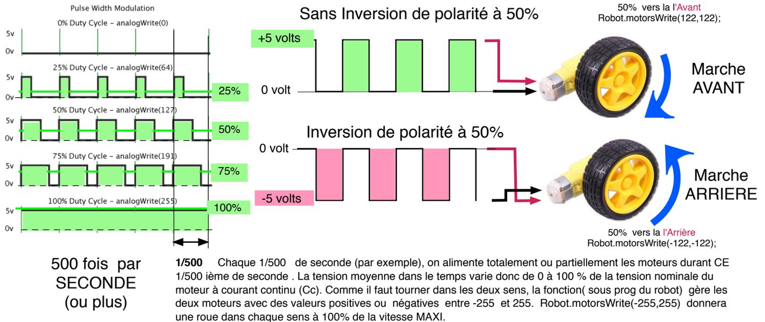
Sur le programme précédent assurer les modifications permettant de remplacer les valeurs fixes de vitesses (ex Robot.motorsWrite(150,-150)) par des valeurs variables : Robot.motorsWrite(valPOT,-valPOT);
