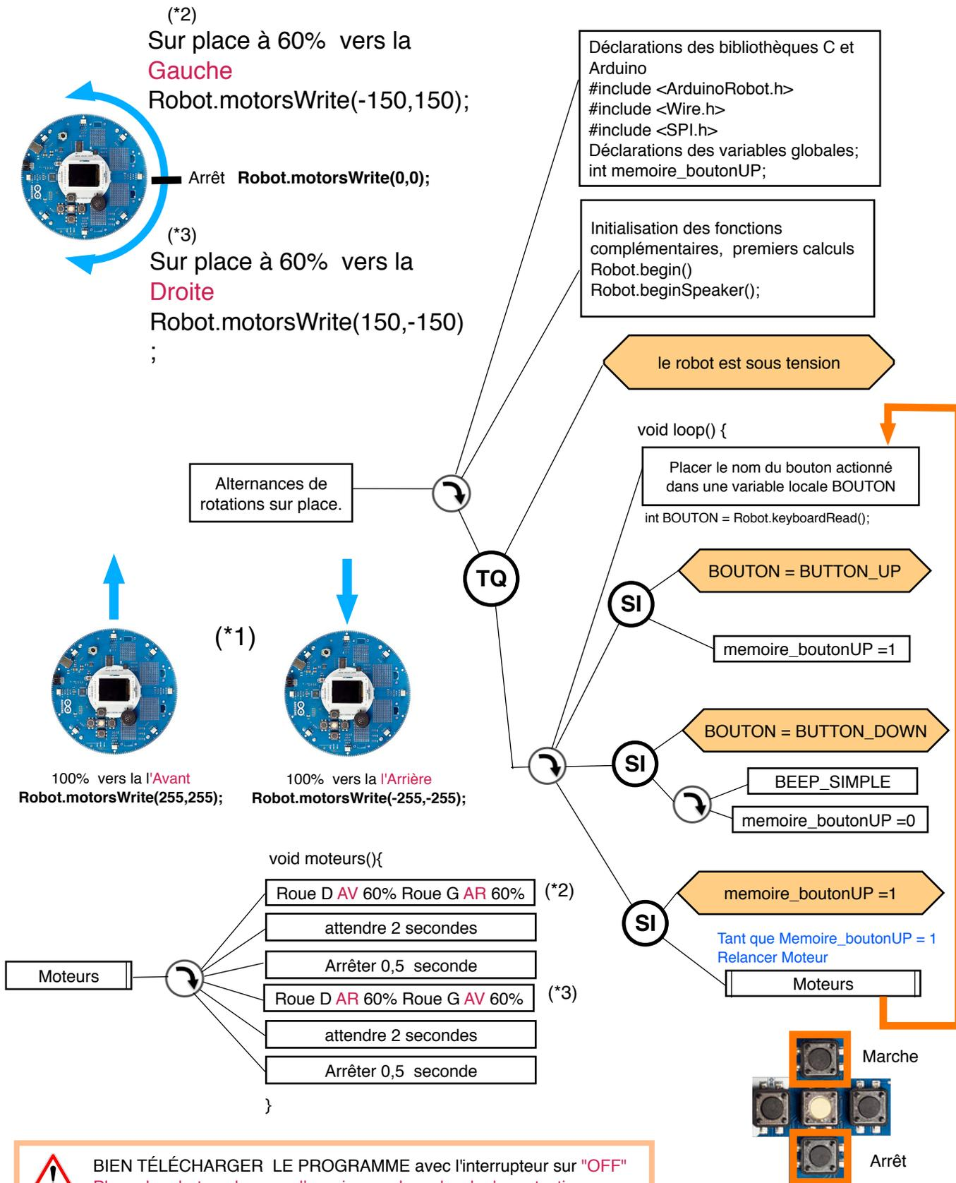
Pour arrêter, il faudra actionner (peut être), plus de 5 secondes, le bouton "DOWN" car la prise en compte se fera à la fin du sous programme "Moteur"
