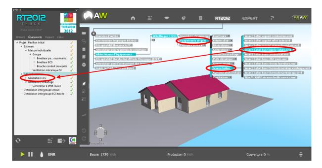
Double-cliquez sur la nouvelle ligne « **Source ballon base boucle solaire** » créée, puis paramétrez la source et la boucle solaire avec les valeurs indiquées ci-dessous, puis <u>validez</u> :
