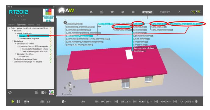
Double-cliquez sur la nouvelle ligne « **Emetteur chaud et froid par soufflage d'air** » créée, puis paramétrez les nouveaux émetteurs avec les valeurs indiquées ci-dessous, puis <u>validez</u> :
