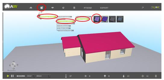
Sélectionner alors un premier « panneau vitré air » et faites le glisser jusque sur le pan de toiture orienté sud.
