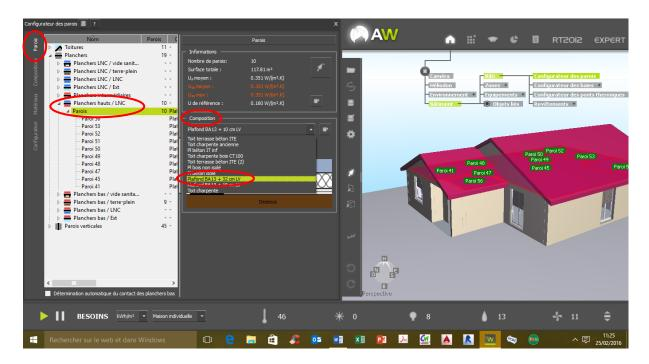
Dans la rubrique « **Planchers hauts / LNC** », sélectionnez la ligne « **Parois** », puis modifiez la composition de la paroi en sélectionnant la paroi « **Plafond BA13 + 32 cm LV** »
