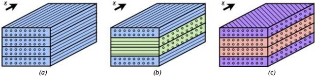
Figure 2 : Trois stratifiés de mêmes dimensions: (a) un [0]4 (unidirectionnel à 4 plis), (b) un [0/90]s, (c) un [+45/-45]s.
