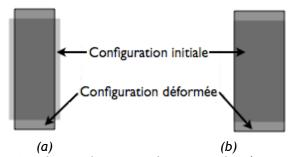
Figure 5 : Modélisation des conditions aux limites appliquées sur une éprouvette : (a) dans le cas idéal d'une traction pure, (b) dans le cas « non idéal » où les extrémités sont serrées.
