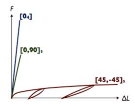
Figure 10 : Comparaison des courbes effort-allongement mesurées sur les trois stratifiés.
