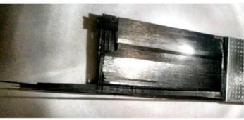
Figure 7 : (a) Radiographie des fissures transverses dans le stratifié, bien avant la rupture (image de Gilles Lubineau) ; (b) éprouvette rompue, où l'on distingue de nombreux délaminages et fissures transverses ainsi que des fibres rompues.
