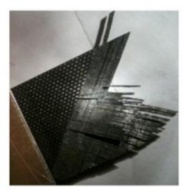
Figure 9 : Eprouvette [45,-45]s rompue ; on distingue de nombreux délaminages et fissures transverses (les dégradations microscopiques sont, par définition, invisibles!)
