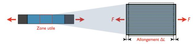
Figure 1 : Essais de traction sur des stratifiés.
