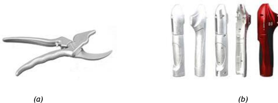
Figure 11 : (a) manches de sécateur FELCO, (b) différentes phases de la coque pour sécateur électrique FELCO (matriçé à chaud, traitée thermiquement, décapée, usinée puis anodisée), images Prétat [3]
