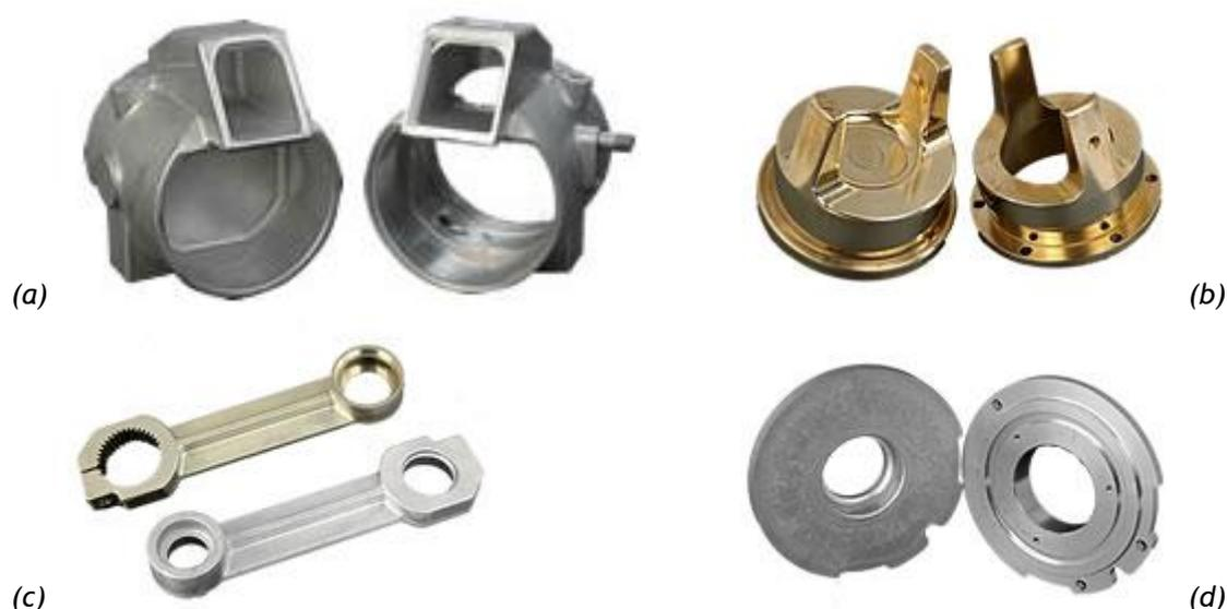
Figure 5 : Exemples de pièces matricées ébavurées, pour chaque duo à gauche avec les surépaisseurs, à droite pièce finie. (a) Corps de caméra sous-marine, (b) raccord rapide pour câble courant fort, (c) levier pour microscope, (d) entretoise pour machine à café.
