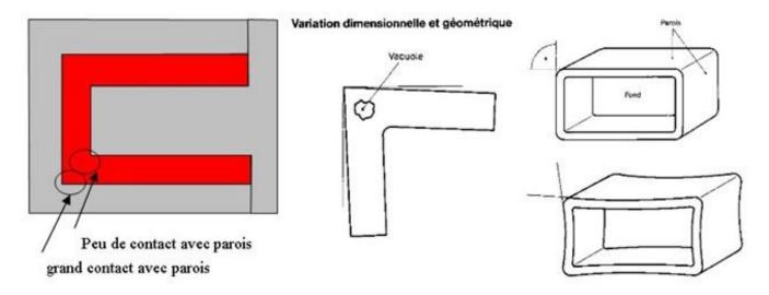
On observe une déformation angulaire due au retrait différentiel. Malgré une température uniforme du moule, le refroidissement local de la pièce moulée varie en fonction de ses surfaces de contact avec les parois du moule : la zone qui a un contact moindre avec le moule va avoir un retrait plus grand.
