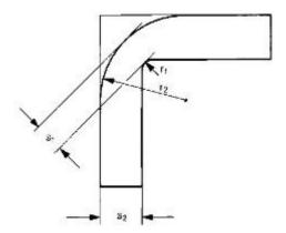
Le même phénomène se produit lors du refroidissement d'un profilé en T. La forme en T induit une surépaisseur locale qui provoque un point chaud et donc un retrait plus important.
