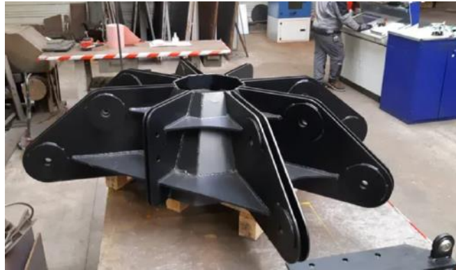
Figure 17 : Clé de voûte métallique, source [38]
