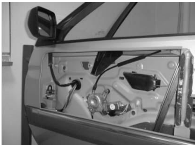
Figure 7 : Implantation du lève-vitre électrique dans une portière
