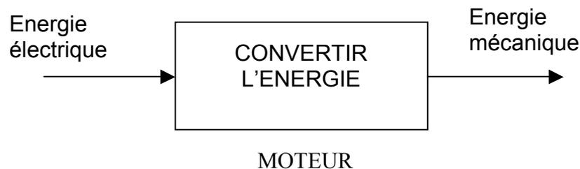
Les machines à courant continu font partie de la famille des actionneurs. Ceux-ci transforment une énergie électrique en une énergie mécanique créant un mouvement de rotation. Les moteurs à courant continu sont employés dans les domaines de la traction ou du levage pour les fortes puissances. Il est également employé, lorsqu'un système utilise une source d'énergie autonome (pile ou batterie).
