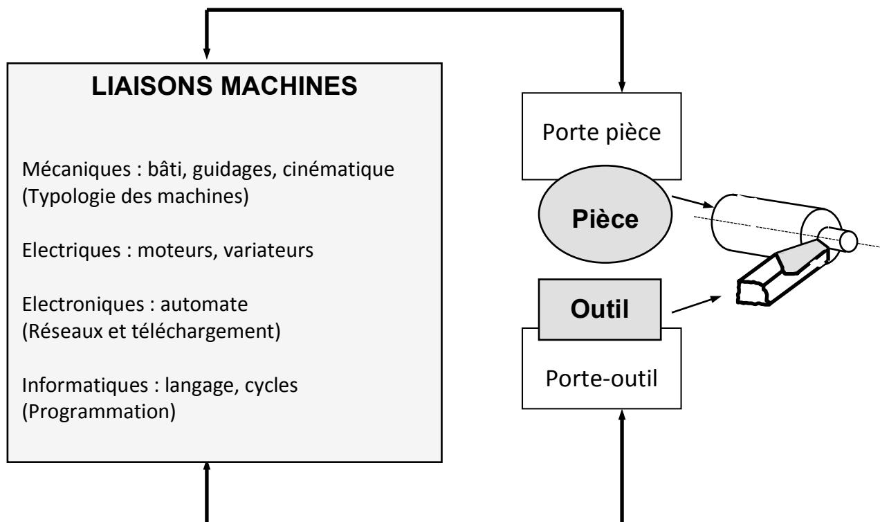
La pièce et l'outil sont fixés sur la machine grâce au porte-pièce et au porte-outil.
