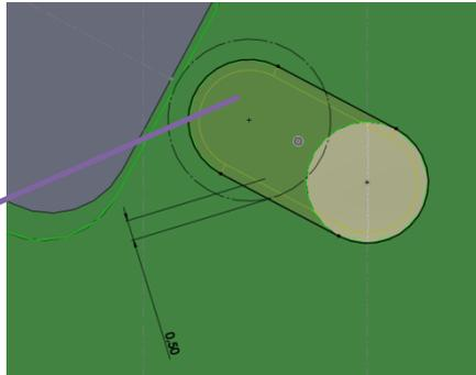
Créer les canaux secondaires par enlèvement de matière extrudée. La profondeur sera fixée à 3 mm avec un angle de dépouille de 5°.
