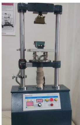
Lors des séances d'activités pratiques de découverte des notions de caractérisations des matériaux, nous avons réalisé des essais de traction sur des pièces plastiques avec la machine de traction. La forme des éprouvettes mise à disposition n'était pas très adaptée à la capacité de notre machine d'essai. Les tests se sont avérés difficiles voire impossibles.
