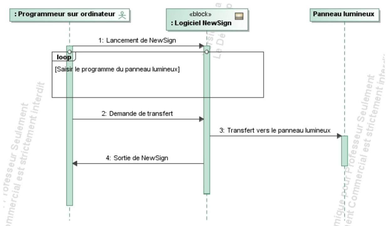
Principe de séquençement de la matrice à LEDs.
