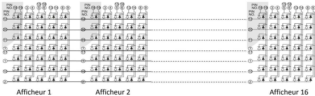
Les anodes sont commandées par des transistors MOS canal P APM4953.
