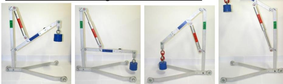
Grâce à ses observations dans différentes configurations de la grue, l'élève formule avec ses mots les principes de la statique pour un solide soumis à 2 forces, 3 forces concourantes et 3 forces parallèle. Le professeur complète et valide les principes. D'autres exploitations sont possibles : notion de moment (basculement) et frontière d'isolement.
