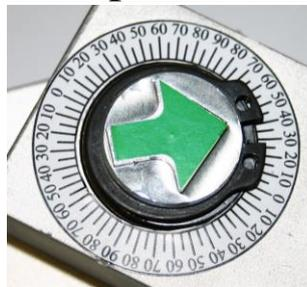
Lorsque l'élève charge la maquette de la grue, il voit les flèches qui tournent pour se stabiliser dans une position d'équilibre. L'élève relève alors la direction des efforts grâce aux secteurs gradués et le sens grâce aux flèches sur chaque pièce (flèches de couleurs suivant l'isolement des pièces ou système).
