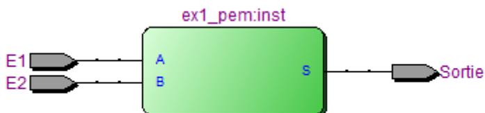
☞ ☞ sur le composant permet de voir la structure logique. (On retrouve celle du schéma), c'est cette dernière qui sera utilisée pour la simulation fonctionnelle.
