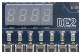
Les sorties d'un compteur étant en binaire, il est nécessaire de disposer d'une fonction « décodeur binaire/ 7- segments ». Cette fonction sera ici écrite en langage VHDL. (le langage VHDL sera étudié ultérieurement)
