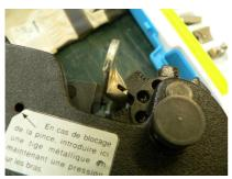
Positionnez correctement la cosse puis sertir en effectuant le mouvement jusqu'au blocage
