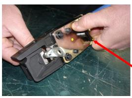
Positionner le câble et son connecteur dans entre les matrices et les refermées manuellement en tournant la poignée
