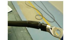
Jusqu'à ce que la gaine thermo rétractable adhère bien au câble et au connecteur
