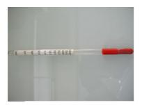
Permet de mesurer la densité d'un liquide fermentescible (ex : le moût) et grâce au tableau ci-dessous d'en déduire son taux de sucre et prévoir le degré alcoolique du futur cidre.
