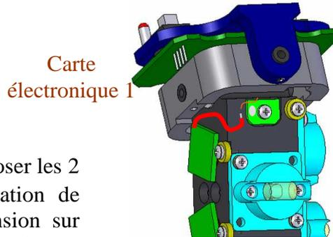
**2** Dessolder le fil souple de sur la 1° plaque bornier.
