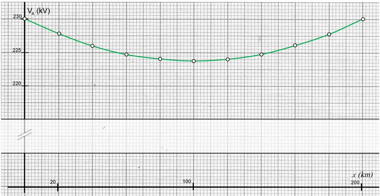
B.6. La tension minimale est-elle respectée en tout point ?  $V_{Amin} = 380 \text{ kV} / \sqrt{3} = 220 \text{ kV}$ . Oui,  $V_A > 220 \text{ kV}$  en tout point !
