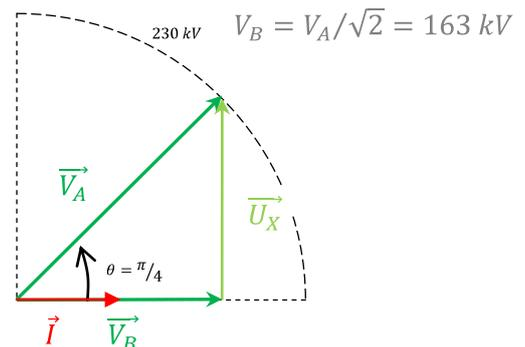
**B. Contrôle de la tension en bout de ligne :  $V_B = V_A$ . Limites**
