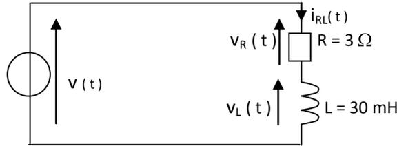
On a mesuré la valeur efficace du courant absorbé par la charge :  $I_{RL} = 23.2 \text{ A}$
