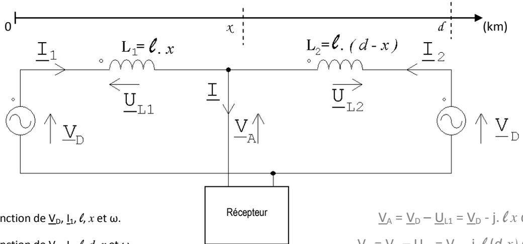
B.1. Exprimez  $\underline{V}_A$  en fonction de  $\underline{V}_D$ ,  $\underline{I}_1$ ,  $\ell$ ,  $x$  et  $\omega$ .
