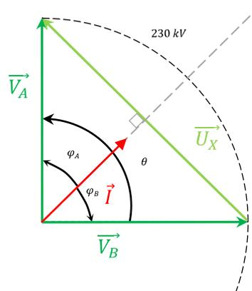
Le dispositif de contrôle de la tension, connecté en tête de la région B, et permettant d'injecter du réactif, est un gradin de 3 condensateurs chacun de capacité  $C = 8 \mu\text{F}$ . Par la suite on notera  $Q_C = -Q_{B'}$  la puissance réactive fournie par le dispositif de contrôle de la tension.
