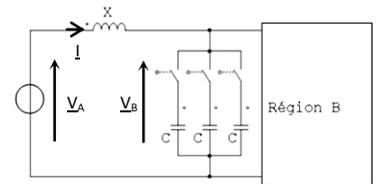
Initialement la tension  $V_B$  est de 163 kV (situation du A.2.7). On connecte sur le gradin 1 condensateur.
