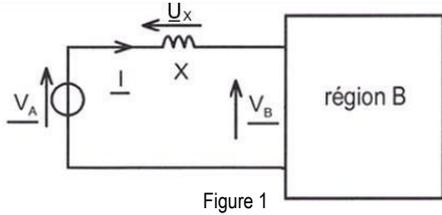
$\varphi_A$  est le déphasage de  $\underline{V}_A$  par rapport à  $\underline{I}$  :  $\varphi_A = (\vec{I}, \vec{V}_A)$
