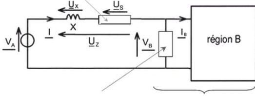
Dispositif de contrôle de la tension
