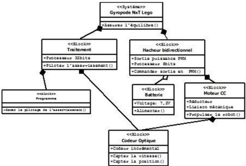
Le traitement numérique dans la brique Lego NxT est scindé en deux parties. Le processeur AVR32 recueille les informations numérique des capteurs et transmet l'ordre de commande à un microcontrôleur ATmega8 chargé de générer les signaux de commande afin de piloter le moteur à courant continu au travers d'une interface de puissance de type Hacheur.
