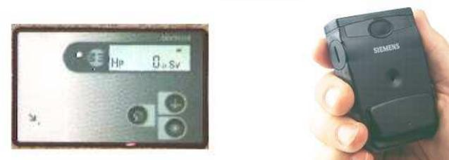
Dosimètre permettant de connaître la **dose en temps réel**. Il peut délivrer des alarmes en cas de dépassement de seuils prééglés par la PCR.
