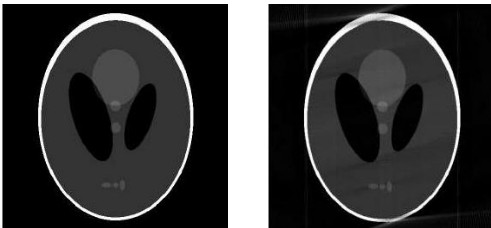
Figure 25 : Comparaison entre l'image originale (à gauche) et l'image reconstruite avec artefact de missing wedge, avec des angles manquants de 15 degrés (à droite). On peut voir les stries orientées dans la même direction sur le fantôme reconstruit avec les angles limités.
