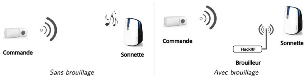
Figure 16 : Principe du brouillage : on approche un HackRF émettant dans la bande ISM 433
