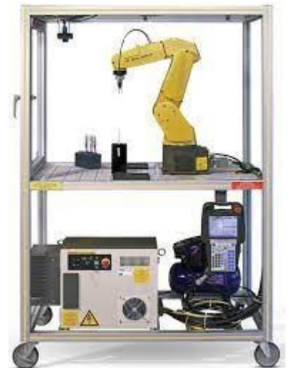
Figure 8 : Cellule robotique éducation
