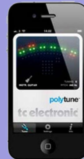
Accordeur polyphonique sur IPHONE : Permet d'accorder plusieurs cordes simultanément
