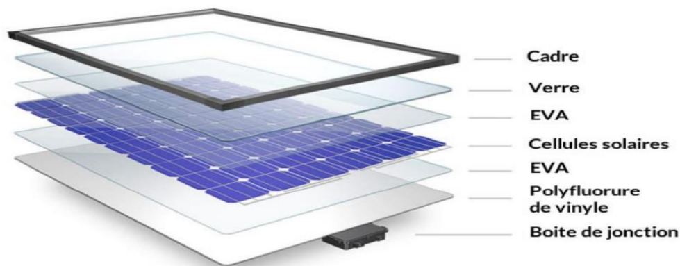
Figure 3 : Composition d'un module photovoltaïque
