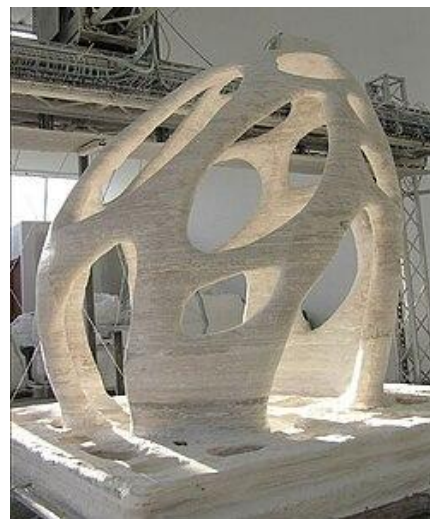
Figure 4 : Structure réalisée en D-shape, source [13]
