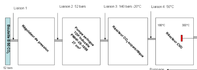
Figure 23 : Représentation d'un réacteur CVD-CO 2 supercritique
