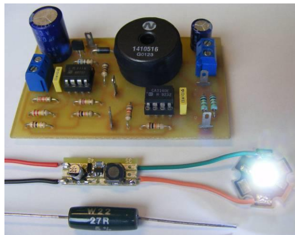
Figure 17 : Trois solutions pour alimenter une led de 1 W avec une batterie de 12V : une résistance, le hacheur utilisant le ZXLD1360 et des CMS (au milieu), le hacheur utilisant des composants traversants non spécialisés (au fond).
