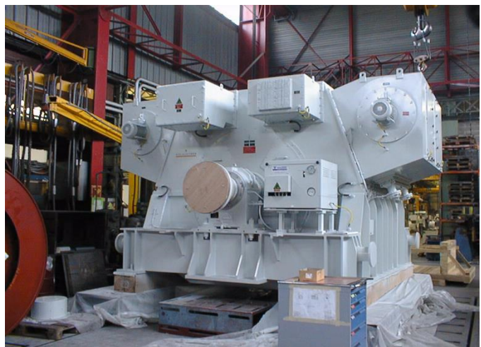
Figure 8 : Exemple de moteur synchrone de propulsion à rotor bobiné (document Alstom)
