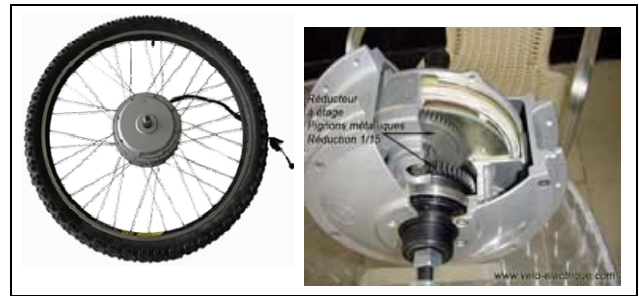
Figure 11 : Moteur roue.
