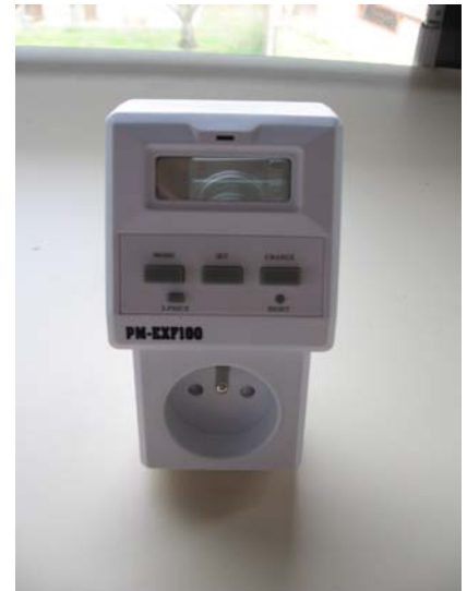
Figure 11: Mesure de la puissance électrique absorbée (PM-EXF100)
