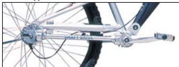
Figure 6 : Transmission par (faux) cardan.
