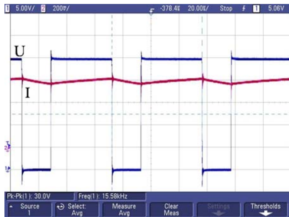
Figure 26 : Relevé instantané de U et de I du moteur M_1 en sortie du hacheur pour une cote de 5%
