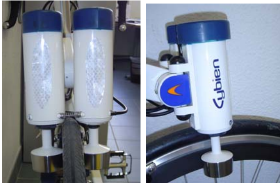
Figure 15 : Les deux moteurs du VAE Cybien
