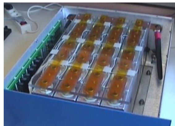
Figure 4 : Le module de supercondensateurs (96F,56V, 400A).
