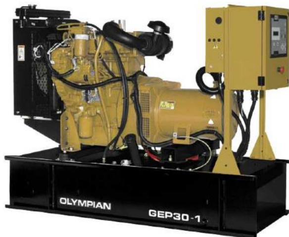
Figure 7 : Groupe électrogène OLYMPIAN™ GEP30-1 Caractéristiques : 380-415 V, 50 Hz, 30 kVA, régulateur de tension R250 ( \pm 0,5\% ), excitation shunt auto-excité, THD V% à vide = 4%.
