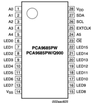
Figure 22 : Configuration des pins, source [Datasheet PCA9685](#)
