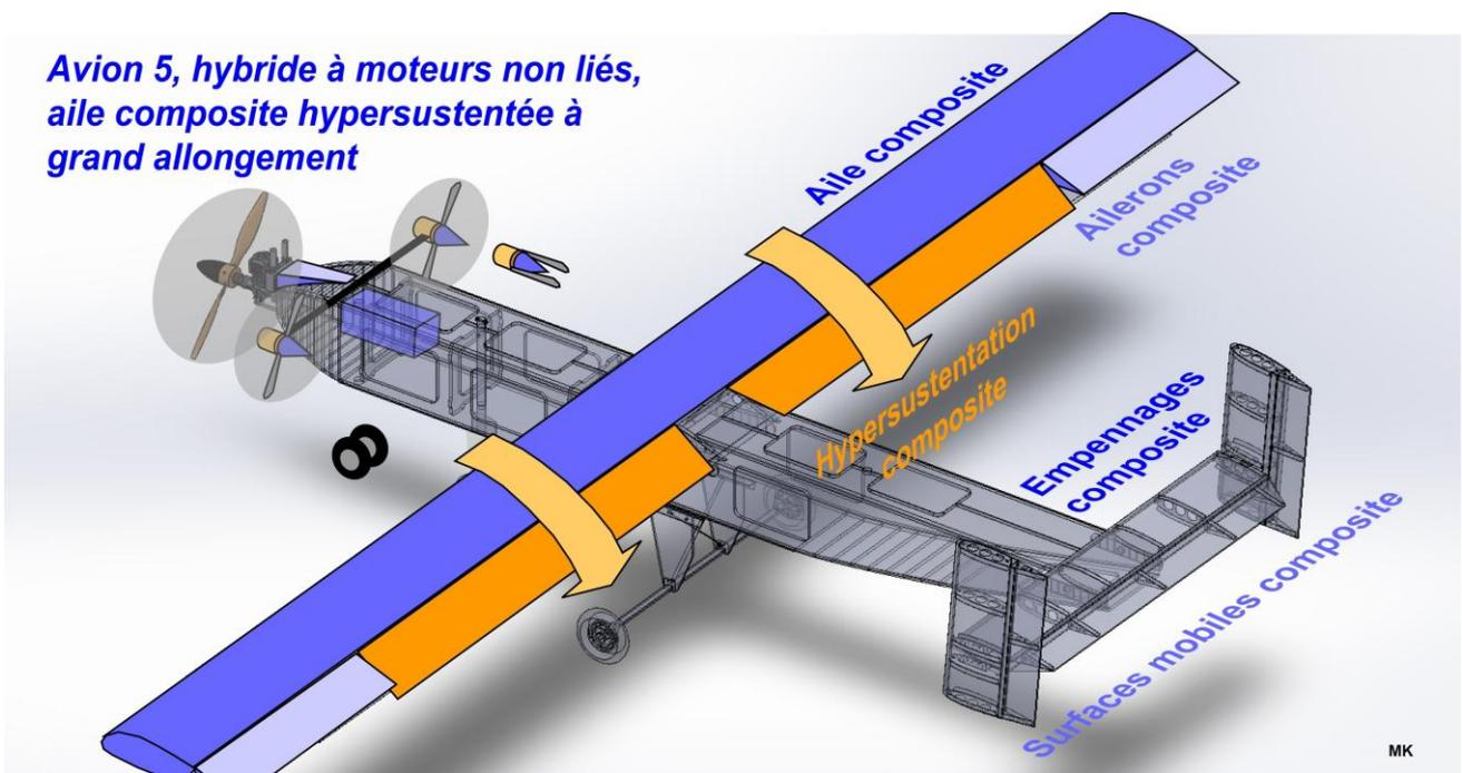
Figure 10 : Avion 5, détails des matériaux utilisés
