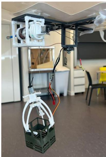
Figure 11 : Dispositif de préhension avec colis
