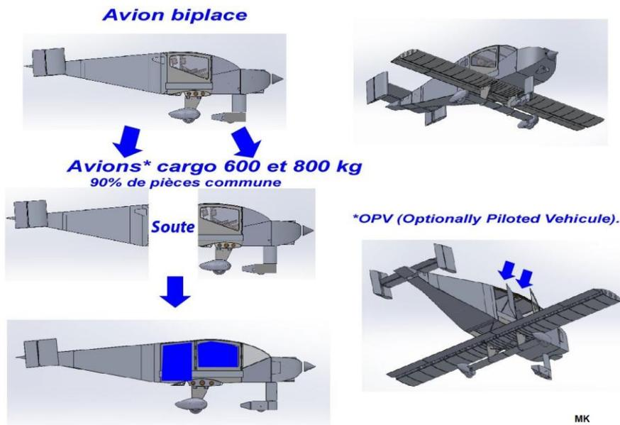
Figure 20 : Similarités avion biplace et avions cargo, l'effet de gamme est à nouveau recherché
