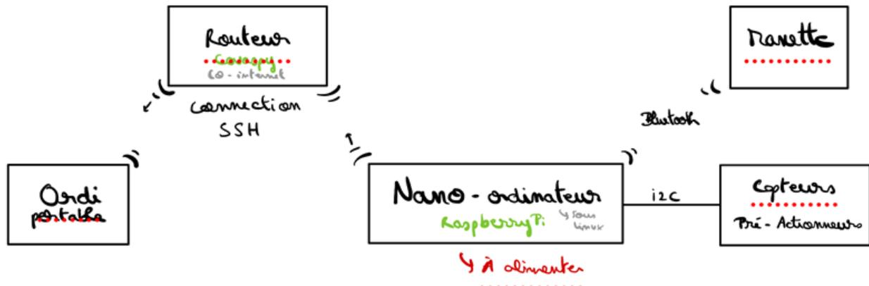
Figure 19 : Éléments communicant avec le microcontrôleur
