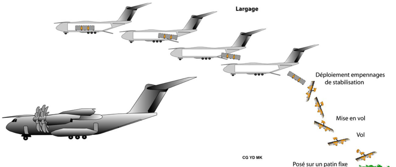
Figure 16 : largage du drone planeur cargo
