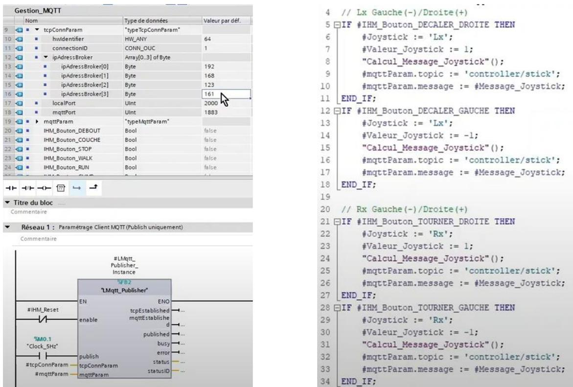
Figure 35 : Exemple de code pour CPU Siemens « LMqtt\_Publisher »
