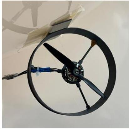
Figure 10 : Structure propulseur latéral
