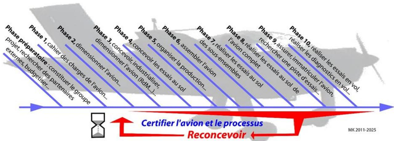
Figure 3 : Synoptique de la conception d'un avion
