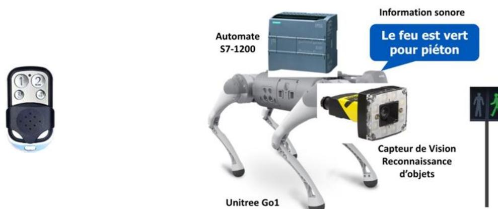
Figure 36 : Le robot-chien pour guide d'aveugle
