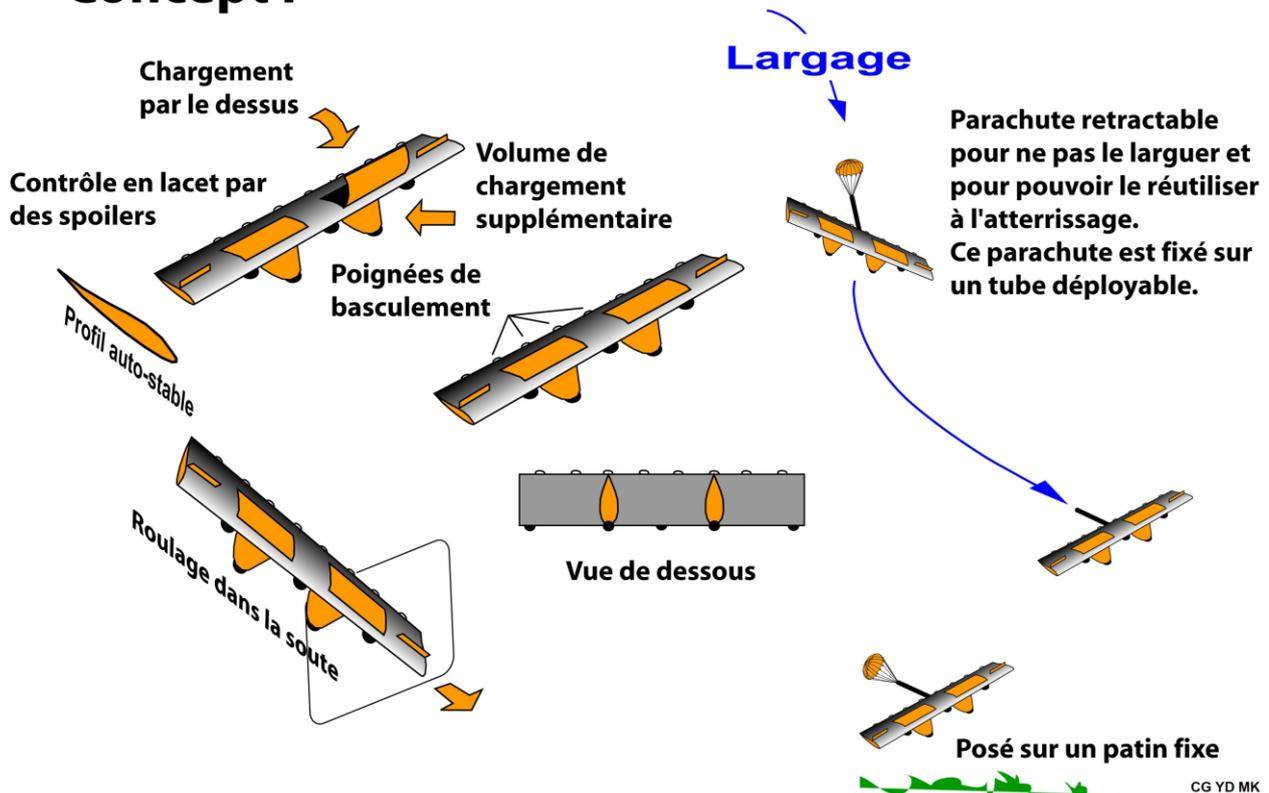
Figure 17 : Concept du drone planeur cargo
