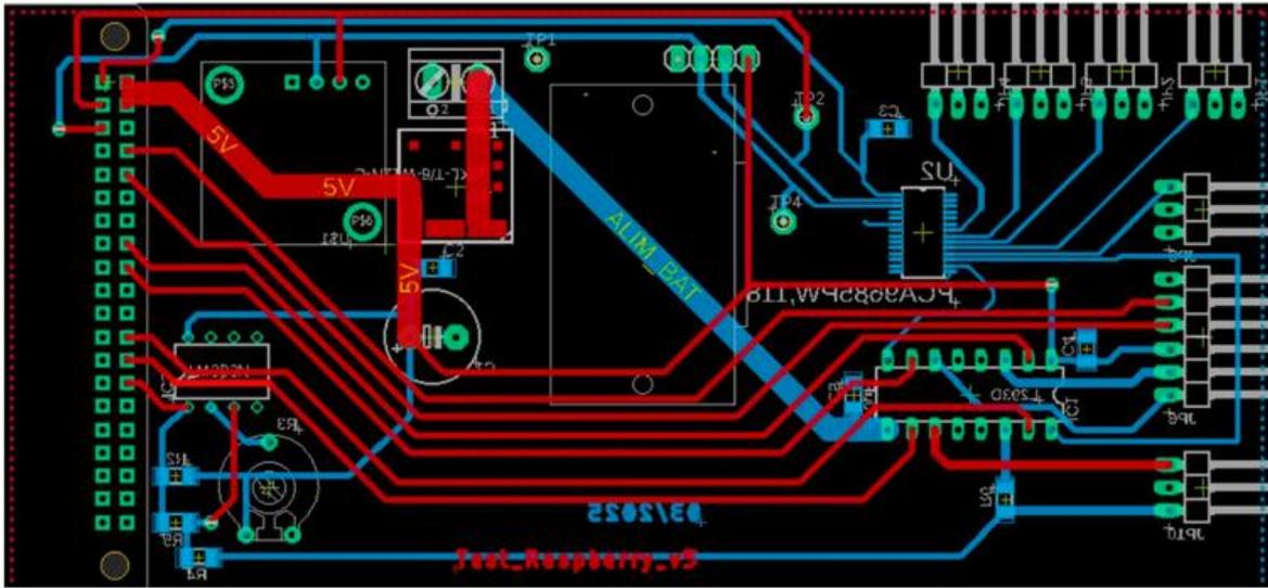
Figure 26 : Carte électronique réalisée sur Eagle
