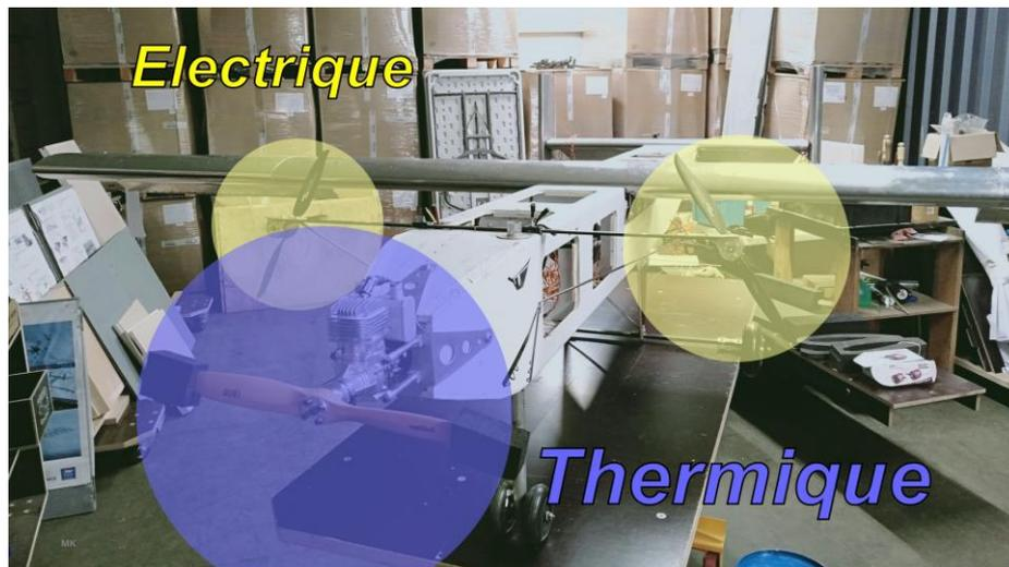
Figure 7 : Avion 4, hybride à moteurs non liés : disposition des motorisations
