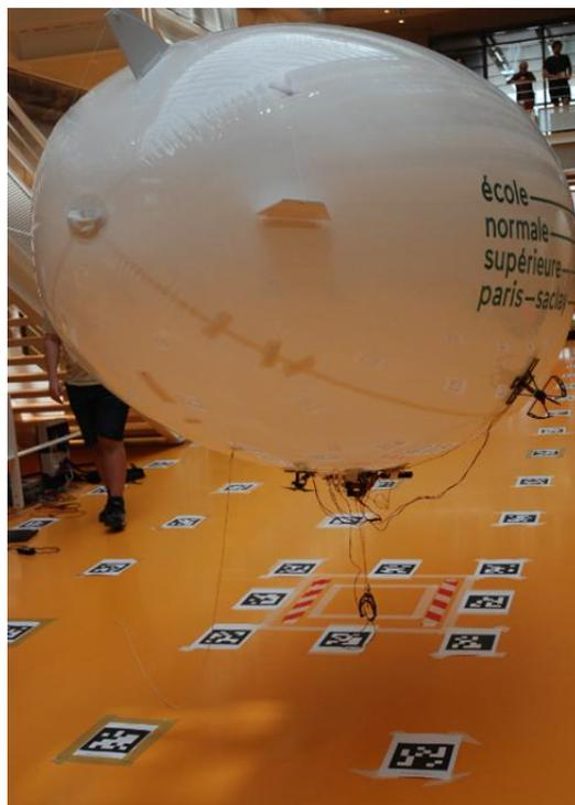
Figure 16 : Dirigeable se déplaçant au-dessus des AprilTags
