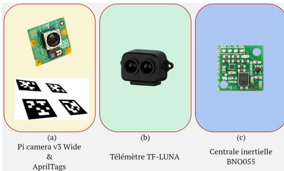
Figure 13 : Capteurs utilisés pour la localisation
