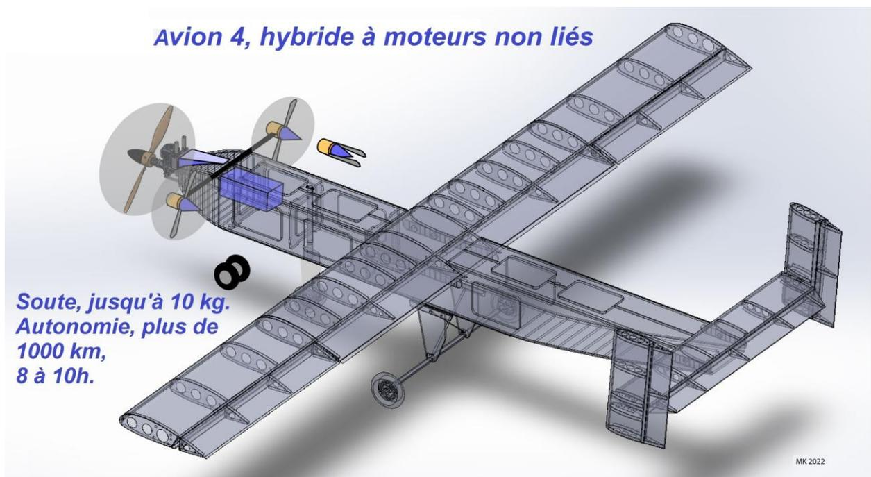
Figure 6 : Avion 4 : hybride à moteurs non liés
