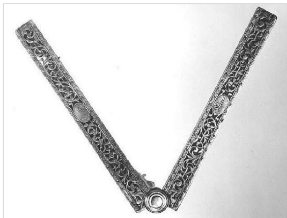
Figure 5 : Demi-pied de Roi pliant en argent du XVIII e siècle, les bords des deux branches sont divisés en 6 pouces, les pouces 1 et 6 sont divisés en 12 lignes, source [23]
