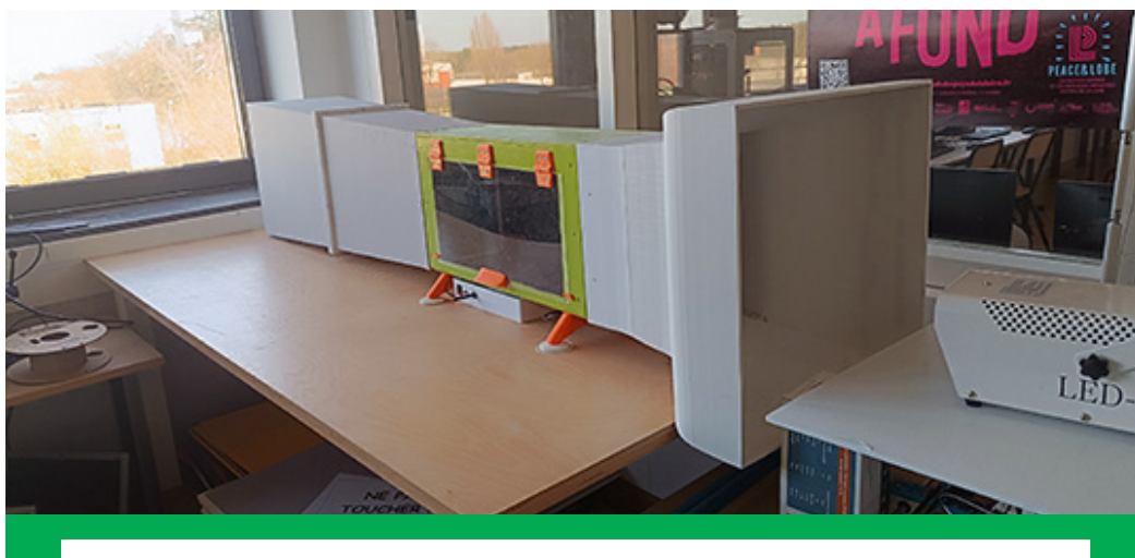
Banc de test en soufflerie, conçu par l'enseignant, utilisé avec une machine à fumée et projecteur utilisé dans le cadre de la préparation au concours « Course en cours ». Collège Henri Lefeuve à Arnage
