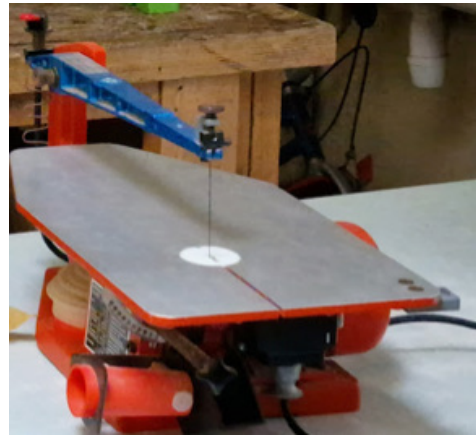
Scie à chantourner si elle n'est pas pourvue d'un carter de protection (peut être utilisée par des élèves si présence d'un carter de protection de la lame)
