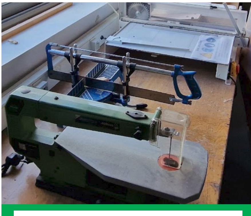
De haut en bas : Scie circulaire cartérisée, scie à onglet manuelle et scie à chantourner cartérisée. Tous ces matériels sont utilisables par des élèves.
