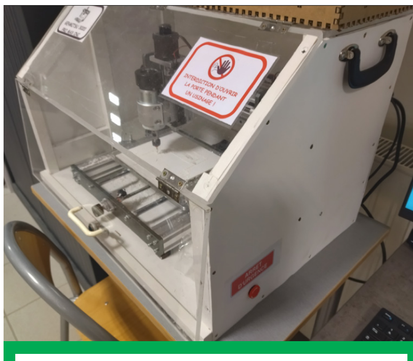
Carter de sécurité, équipé d'un verrouillage et d'un arrêt d'urgence, réalisé par le professeur. Dans le cas d'une imprimante 3D, on pourrait y ajouter un dispositif d'aspiration et de filtrage des COV. Collège Simone Veil à Nantes
