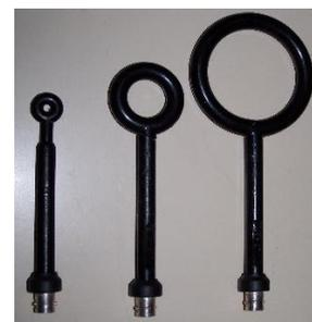
a) Principe de l'antenne boucle
