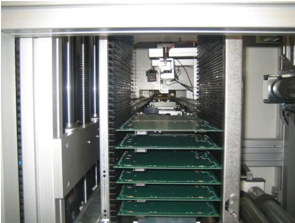
Figure 1 : Rack avec circuits stockés
