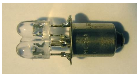
Figure 14 : Trois LED blanches soudées sur le culot de l'ampoule à incandescence d'une lampe de poche.
