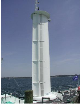
Figure 2 : La turbo-voile de l'Alcyon photo de l'université de Rhode island [5]
