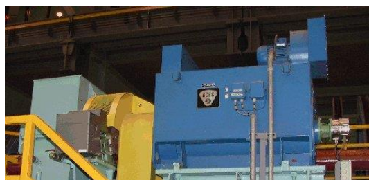
Figure 14 : Le moteur, le générateur d'impulsion, le ventilateur
