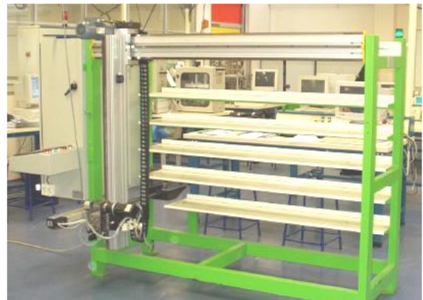
Figure 1 : Photo du transtockeur réalisé
