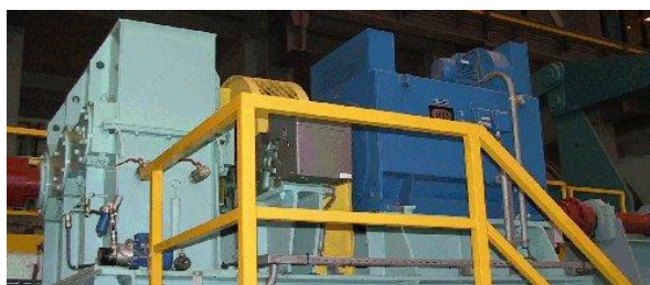
Figure 13 : Vue du réducteur grande vitesse et du moteur
