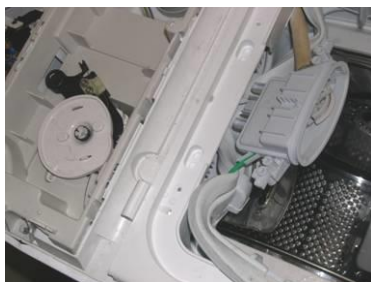
Figure 13 : Appareil équipé d'un distributeur d'eau (1 seule électrovanne)
