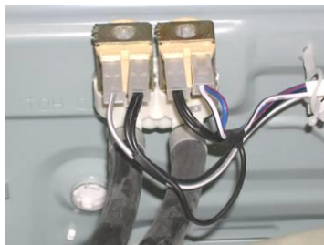
Figure 16 : Dispositif à 2 électrovannes
