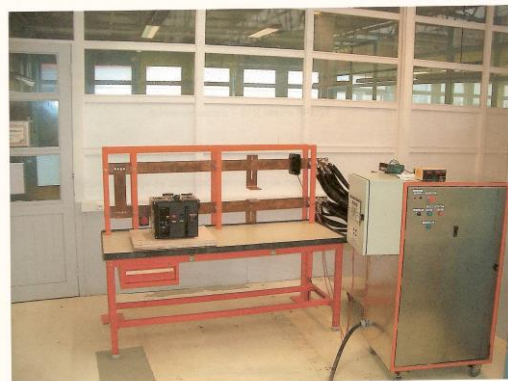
Figure 1 : Banc de tarage de disjoncteur
