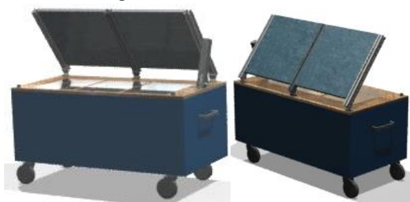
Figure 17 : Vues d'ensemble de la maquette. 3 platines (1, 2 et 3) sont représentées, le plan de charge est mobile.
