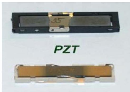
Figure 3 : Transformateur piézoélectrique
