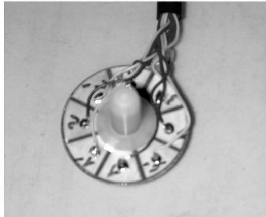
Figure 4 Transformateur piezoélectrique à base d'anneaux sectorisés
