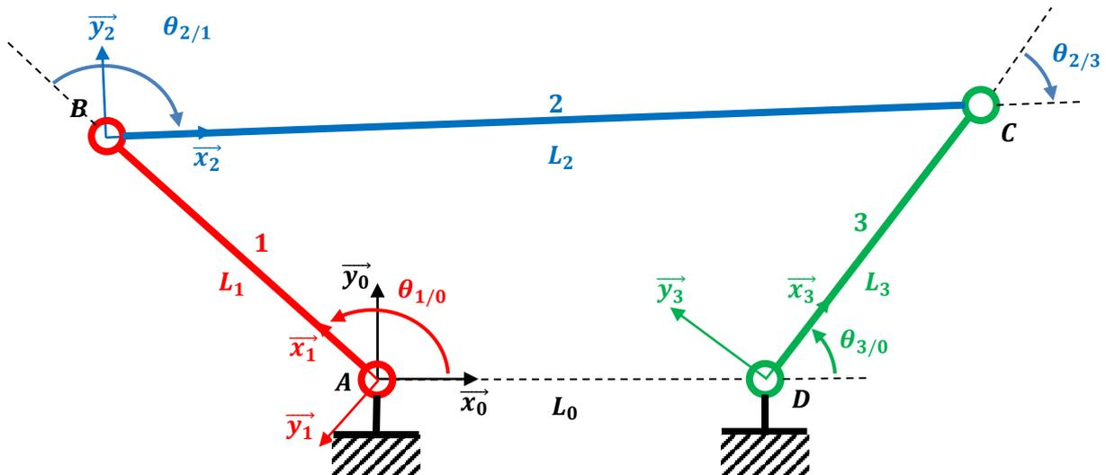
**Question 1:** Ecrire la fermeture de chaîne géométrique du système et en déduire les 3 équations scalaires associées par projection dans la base 0
