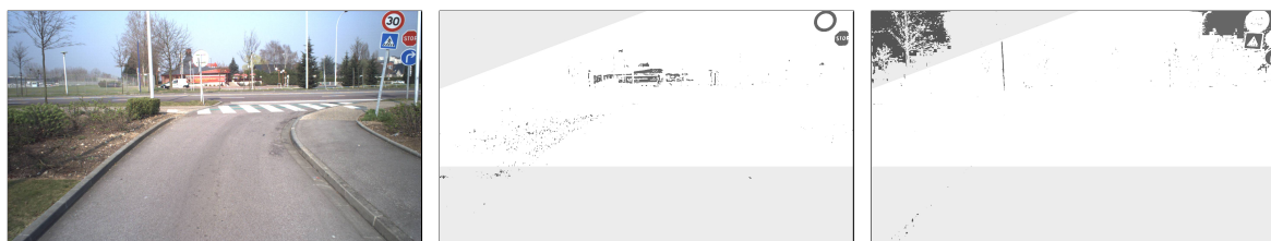
FIG. 3.2 – (à gauche) Exemple de scène routière ; (au milieu) classification des pixels rouge/non rouge ; (à droite) classification des pixels bleu/non bleu (à droite). La région d'intérêt correspond à la zone non grisée.
