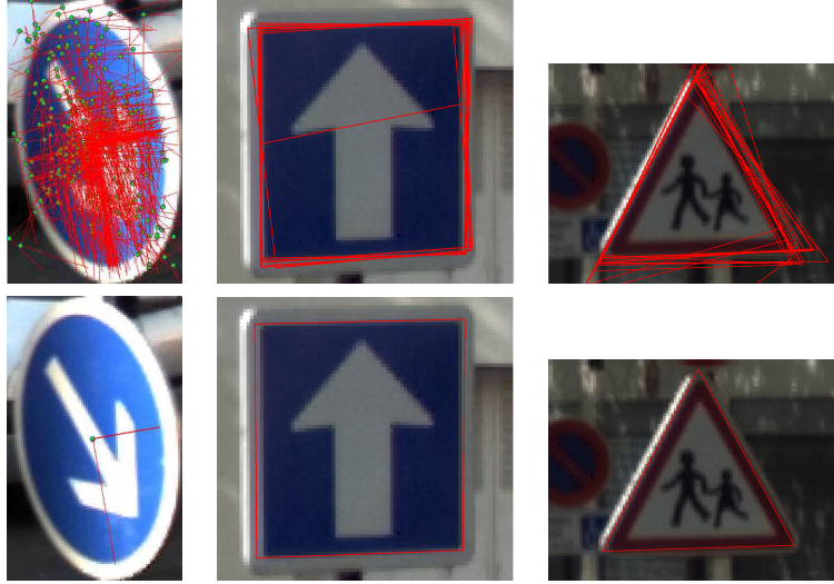
FIG. 4.4 – (En haut) Les n ellipses, rectangles et triangles estimés par RANSAC. (En bas) Les solutions acceptées.
