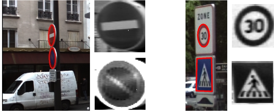
FIG. 4.6 – Rectification de panneaux dans le cas de déformations perspectives très fortes.
