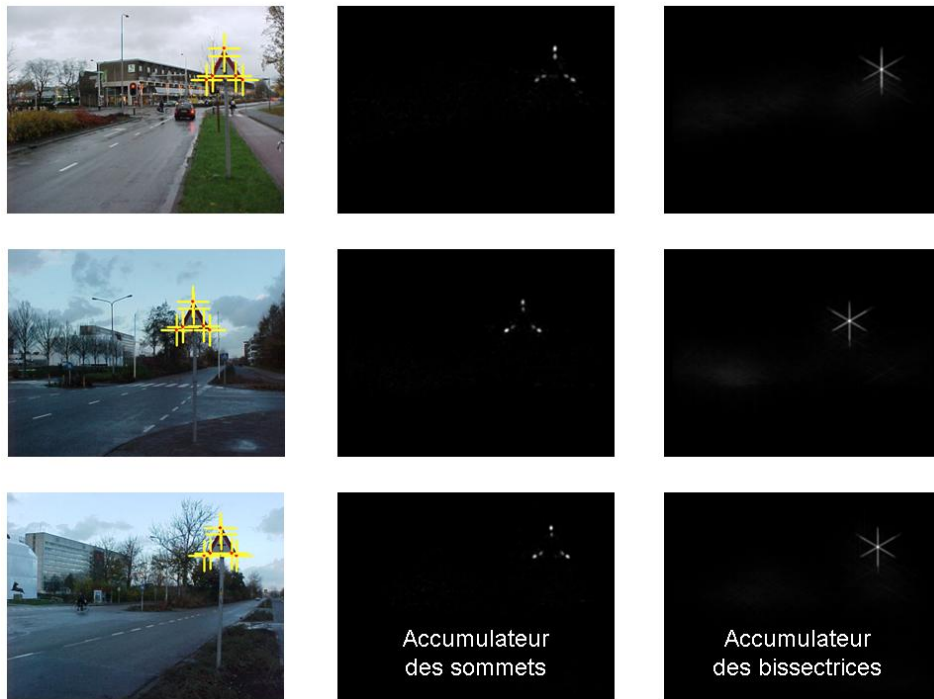
FIG. 5.11 – Exemples de segmentation de panneaux par TCB sur une scène urbaine (base de test Paris 15°).
