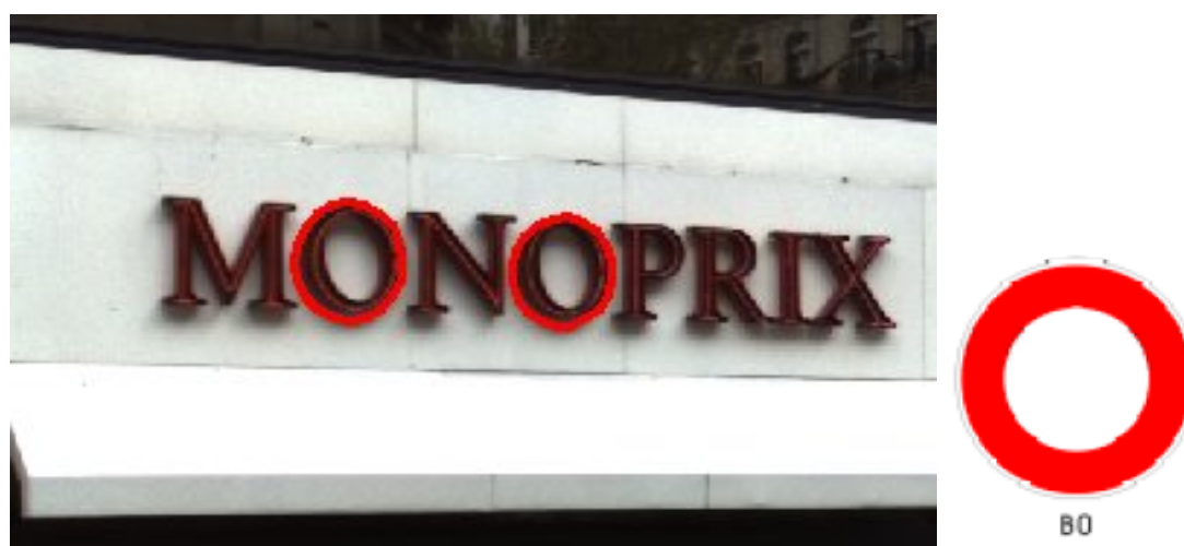
FIG. 4.11 – Exemple de fausse alarme : ressemblance de la lettre « O » et le panneau « circulation interdite ».
