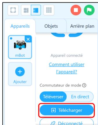
**Une fois téléchargés, pour faire fonctionner le code, il faudra appuyer sur le bouton poussoir sur le côté du capot pour mettre en fonctionnement le programme.**
