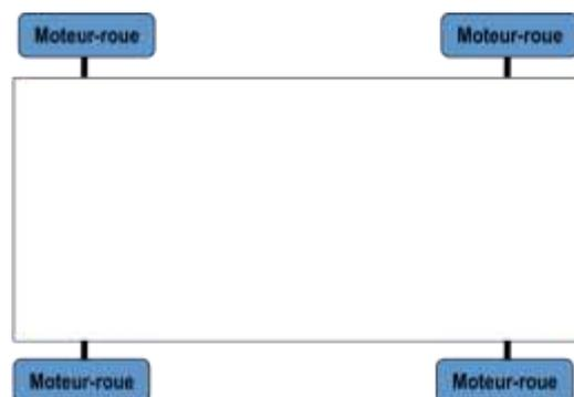
**Figure 5 :** Architecture de véhicule électrique avec moteurs intégrés dans les roues
