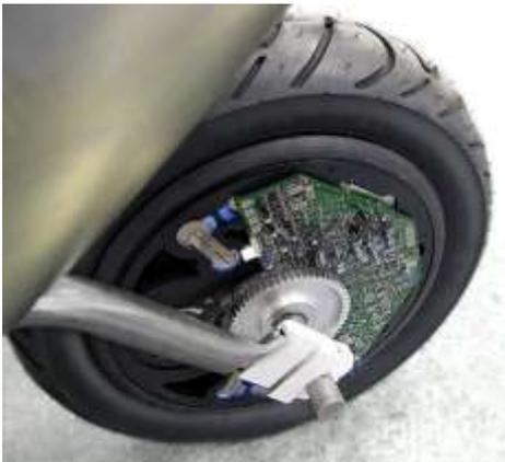
Figure 14 : Moteur-roue Ez-Wheel
