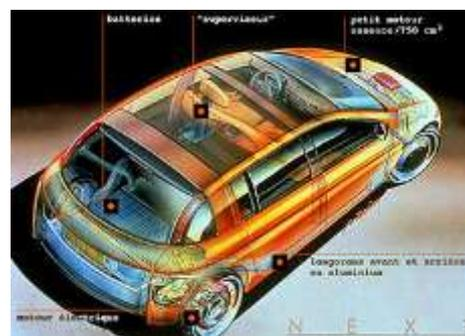
**Figure 7 :** Renault NEXT – un exemple de véhicule hybride à moteurs intégrés dans les roues arrière
