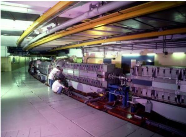
Figure 2 : l'accélérateur PS avec au centre un aimant principal et la chambre à vide où circule le faisceau
