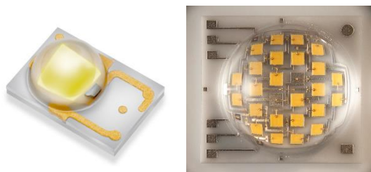
Figure 2 : A gauche, une led Luxeon-Rebel (PHILIPS-LUMILEDS), à droite un assemble de plusieurs leds dans un même boîtier (CREE XLamp® MP-L EasyWhite™ LED)
