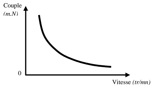
Caract ristique « Couple – Vitesse » du moteur   courant continu (excitation s rie)
