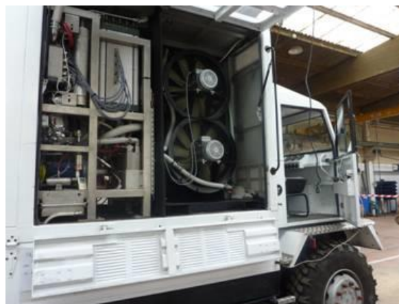
Figure 9 : Vue sur la PAC installée sur la plateforme du Banc ECCE
