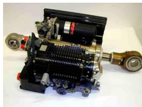
Figure 2 : Electro-Hydrostatic Actuators (EHA) Actionneur commande de vol - Elévateur A380
