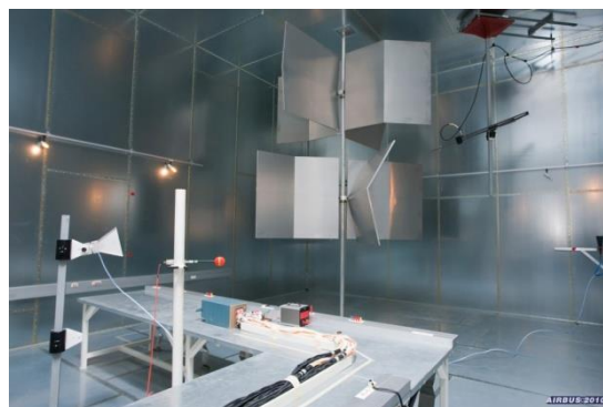
Figure 7 : Essai en susceptibilité rayonnée – Chambre Réverbérante à Brassage de Mode
