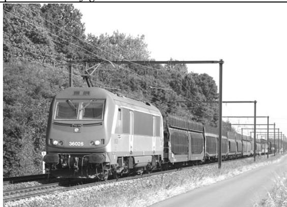
**Figure 280** : Vue de la *BB 36026* de 5600 kW de la SNCF. Les 4 moteurs asynchrones sont alimentés par des onduleurs de tension à GTO de 4500 V - 4000 A.
