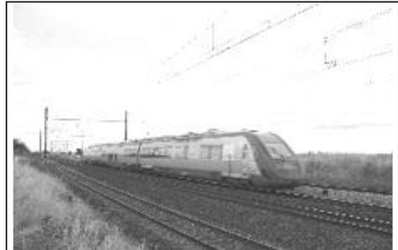
**Figure 297 :** Vue d'un élément automoteur électrique rapide Z TER (Z 21500) de 1700 kW, en essais dans la Beauce. A 3 caisses, de configuration M + R + M, ces rames régionales sont susceptibles de circuler à 200 km/h pour des dessertes de ville à ville. 3 éléments peuvent être accouplés en "UM".
