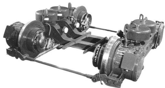
*Figure 295 : Photographie d'un bogie de tramway à 4 "moteurs-roues". Les moteurs asynchrones, de la famille "ONIX", sont logés dans ce que l'on appelle communément les boîtes d'essieux, tandis que les réducteurs sont incorporés dans le corps des roues elles-mêmes ; on remarque également la présence, sur les faces intérieures des roues, des disques de freinage.*
