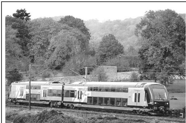
**Figure 296 :** Une automotrice régionale TER 2N de la série Z 23500. De configuration M + R, ces rames sont équipées de 4 moteurs asynchrones de 430 kW alimentés par des onduleurs à IGBT de 3300 V - 120 A.
