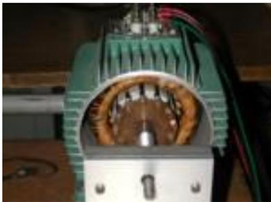
**Figure 3 :** Les moteurs asynchrones sont les premières victimes d'un taux d'inverse excessif
