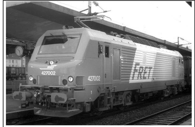
Figure 299 : La locomotive "fret" BB 27002 de 4200 kW de la SNCF. Ces locomotives spécifiques ont une vitesse maximale de 140 km/h.
