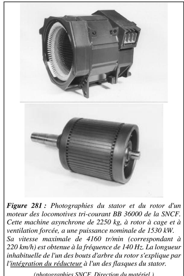
**Figure 281** : Photographies du stator et du rotor d'un moteur des locomotives tri-courant BB 36000 de la SNCF. Cette machine asynchrone de 2250 kg, à rotor à cage et à ventilation forcée, a une puissance nominale de 1530 kW. Sa vitesse maximale de 4160 tr/min (correspondant à 220 km/h) est obtenue à la fréquence de 140 Hz. La longueur inhabituelle de l'un des bouts d'arbre du rotor s'explique par l'intégration du réducteur à l'un des flasques du stator.
