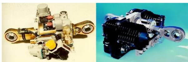
**Figure 5 :** Evolution des actionneurs de commande de vol. A gauche, une servocommande traditionnelle, alimentée par l'hydraulique avion. A droite, un EHA, alimenté par l'électricité avion, mais recréant une hydraulique locale pour mouvoir le vérin.
