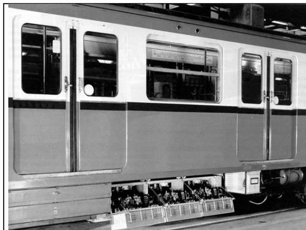
*Figure 262 : Vue du coffre onduleur de l'équipement prototype GEC-Alstom de 500 kW installé sur la motrice M 10024 de la RATP ; un 2<sup>ème</sup> coffre, contenant l'appareillage, est installé sous la face opposée. Cette figure montre les 3 panneaux ouverts (chacun constituant une phase) leur refroidissement est assuré par convection naturelle. (photographie extraite de la Revue GEC-Alstom n°8)*
