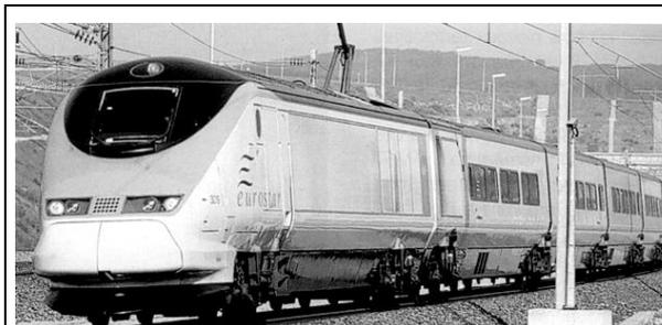
**Figure 273** Vue d'une rame tricourant TGV TransManche du parc "Eurostar". La rame complète de 18 remorques encadrées par 2 motrices a une longueur d'environ 400 m, sa masse en charge est de 816 tonnes ; la puissance totale de 12 MW, développée seulement sous 25 kV, permet une vitesse maximale à 300 km/h.
