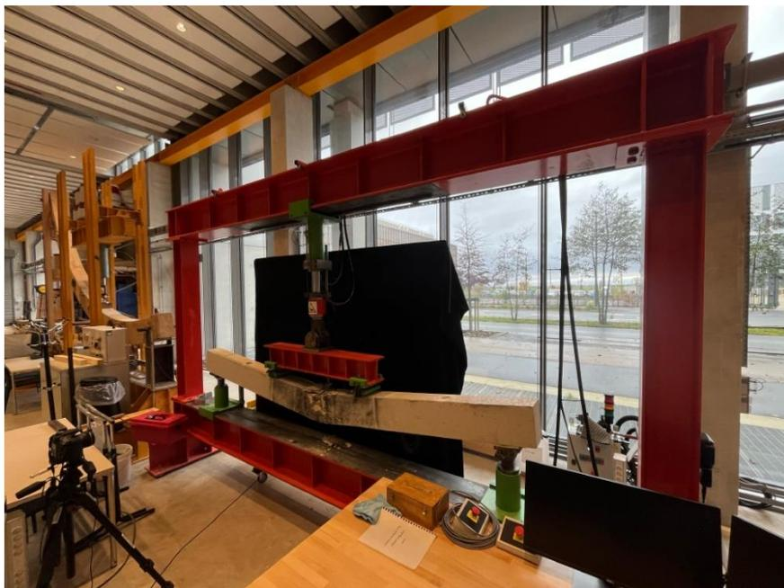
Figure 2 : Dispositif expérimental utilisé pour la mesure par CIN. La photo est prise après la ruine de la poutre
