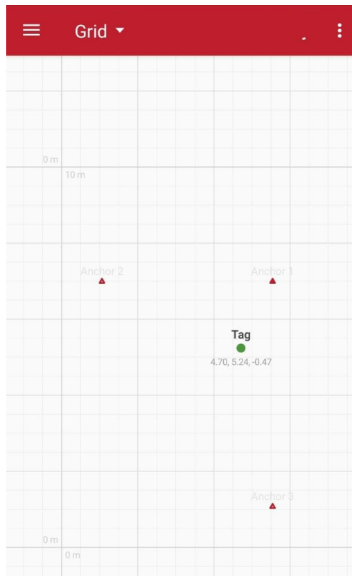
Figure 11 : Page de localisation de l'application Decawave
